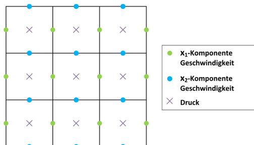
Das MAC Schema verwendet Finite Differenzen auf einem „staggered grid“. Dabei werden die Druckkomponenten im Zellmittelpunkt definiert und die Geschwindigkeitskomponenten an den Zellkanten. Für den Laplace Operator wird der 5-Punkte Stern verwendet und für die Divergenz wird eine 2-Punkte Differenz in der entsprechenden Richtung berechnet.
